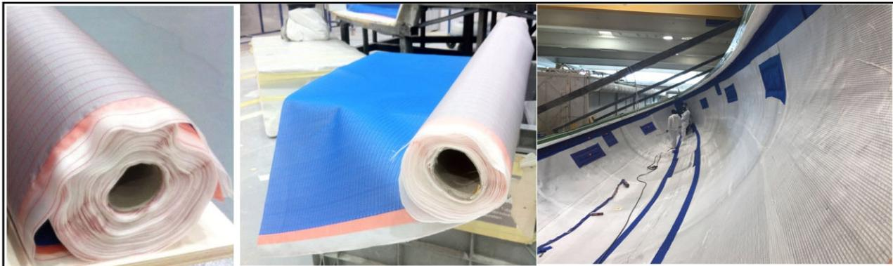
Rete in Poliestere a maglia tridimensionale conformabile , accoppiata ad un film distaccante microforato e tessuto distaccante Peelply, utilizzata nei processi di laminazione per infusione sottovuoto. Permette una omogenea distribuzione della resina nel laminato ed un flusso regolare di aria in superficie.La combinazione dei tre materiali velocizza le operazioni di stesura dei consumabili,con un notevole risparmio in termini di tempo. **NON CONTIENE PARAFFINE**
